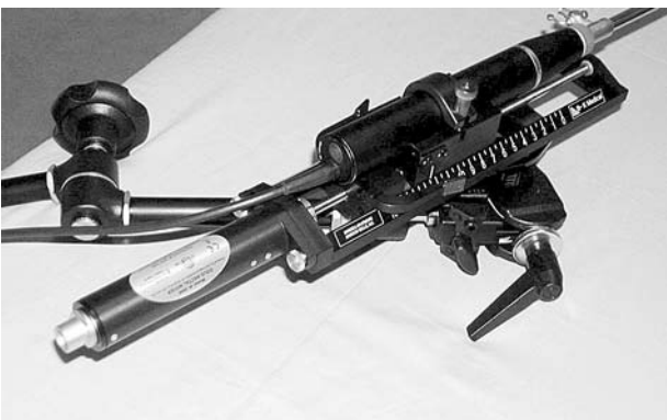
Мал. 3. Пристрій для контрольованого руху порожнинних датчиків, змонтований на фіксаторі, з датчиком 1850.
