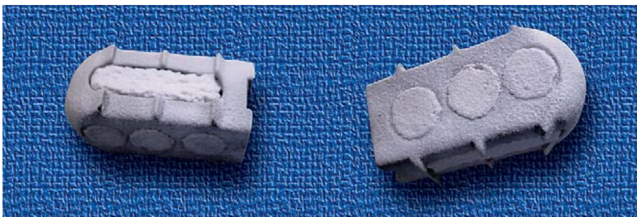
Рис. 2. Межтеловой имплантат, покрытый и заполненный гидроксипатитной керамикой.
